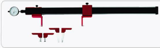
Calibro basculante a comparazione per il controllo di interni ed esterni, per il controllo di dentature, filettature, gole e sedi di vario genere tramite puntalini intercambiabili
