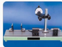
Banchi di azzerramento e controllo alesametri e strumenti di misura
