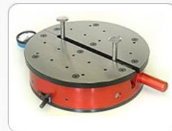
Banchi modulari per controlli di concentricità, rettilineità, perpendicolarità e di forma
