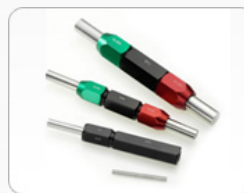
Tamponi reversibili p/np (composti da impugnatura con ogive di bloccaggio e spine p/np, particolarmente indicati per il controllo di piccoli fori)
