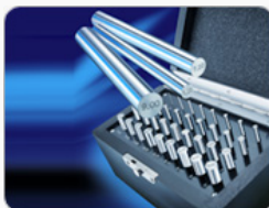
Spine cilindriche calibrate in acciaio fornite singole e in composizioni standard e speciali a partire dal diametro 0,1 mm con dimensioni centesimali o millesimali e tolleranze millesimali
